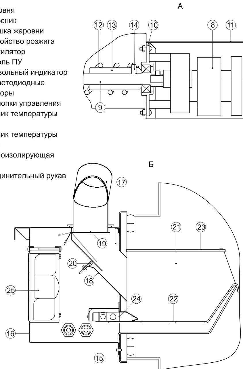
загрузочной дверце котлов модельного ряда «Куппер», и закрыто корпусом ⑯, защищающим его от попадания пыли и посторонних предметов. Из патрубка загрузочного ⑰, связанного соединительным рукавом ⑳ с бункером, топливо попадает в лоток загрузочный ⑱, в котором установлен клапан ⑲, предотвращающий попадание пламени в загрузочный патрубок в случае аварийных ситуаций. Также в загрузочном лотке находится датчик пламени ⑳.
