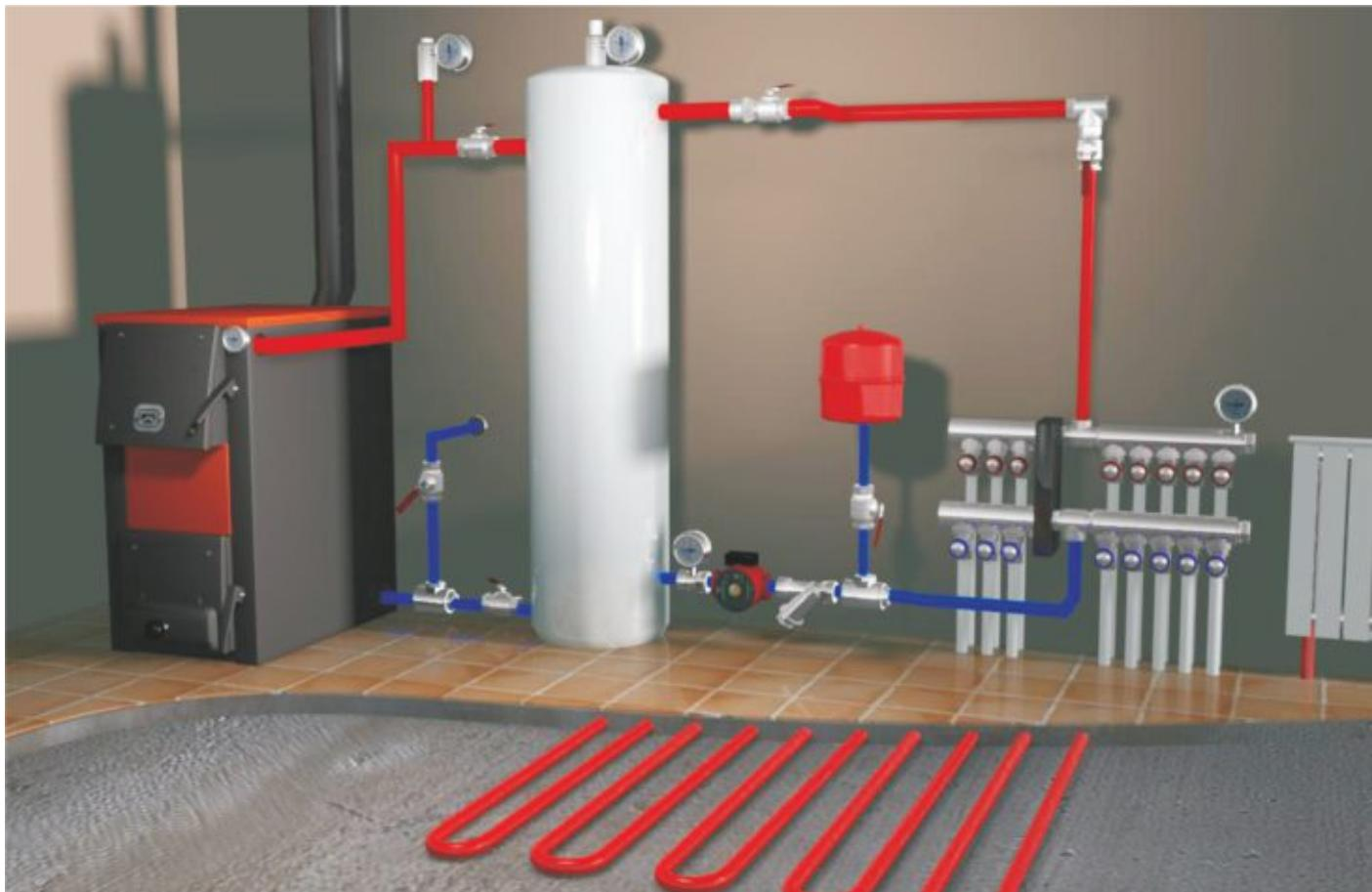
Котел «Куппер» соединен через емкостной гидравлический разделитель с закрытой системой радиаторного отопления и теплых полов и принудительной циркуляцией. В случае, если не требуется подготовка горячей воды, схема собирается без установки бойлера.
