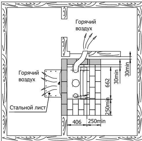
Рис.3 Схема установки камина с воздуховодами
