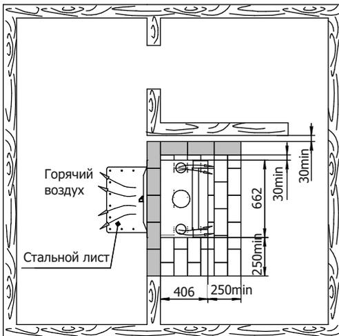
Рис.2 Схема установки камина без воздуховодов
